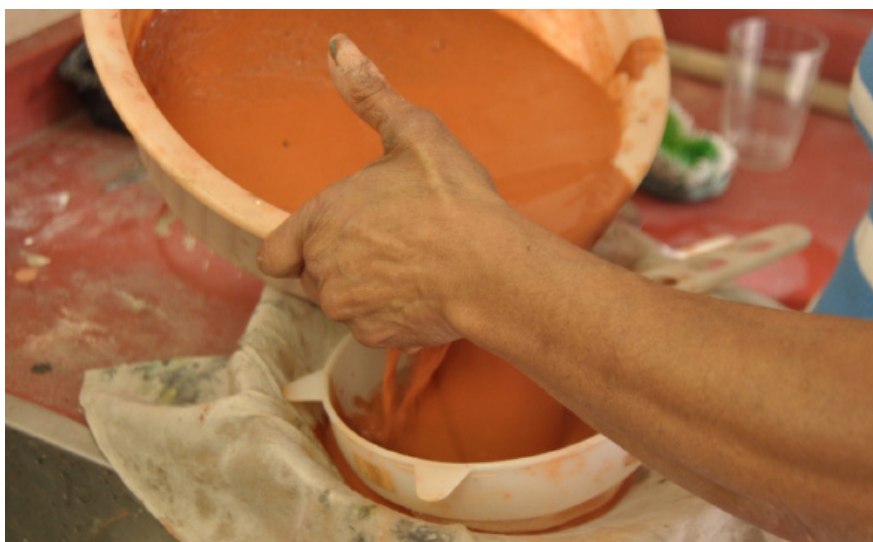
Figura 31 - Depois de dissolvido, passa-se o barro com a água por uma peneira com um pano embaixo, para que seja extraída somente a tinta, sem excessos de água.
