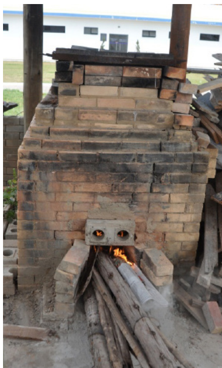
Figura 16 – A lenha é colocada bem no início do forno e então ele é acendido. É importante que a lenha esteja bem na entrada do forno. Inicia-se o esquite. Ele é feito por em média 4 horas, no qual a lenha é empurrada gradativamente para dentro do forno.
