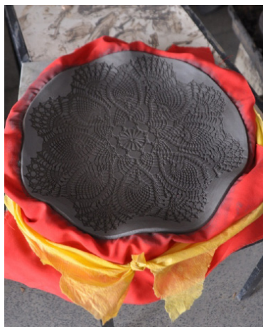
Figura 72 - Após totalmente seca, já em ponto de queima, a peça vai ao forno.
