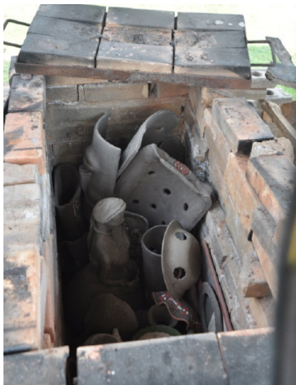
Figura 13 - As peças são organizadas dentro do forno, aquelas que forem mais grossas ficam por baixo, as mais delicadas e leves são empilhadas por cima.
