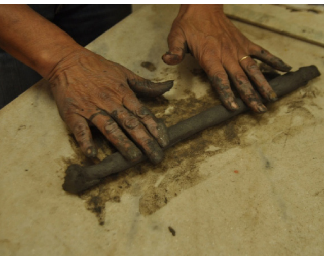
Figura 42 - Começa-se a preparar as “cobrinhas”, elas não podem ser muito finas para que não quebrem.
