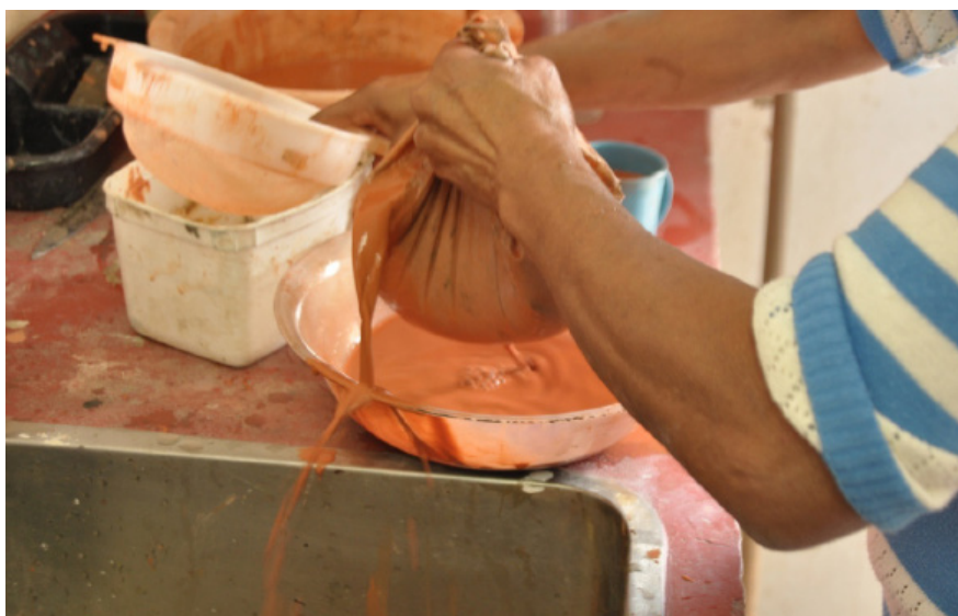
Figura 33 - Quando o barro, que está misturado com a água, estiver peneirado, ele passa ainda pelo pano para ser coado e retirado qualquer resíduo que ainda estiver presente, deixando-o mais puro.
