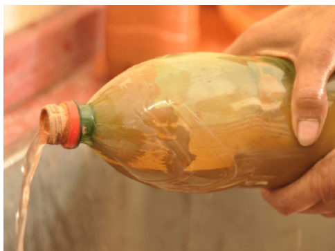
Figura 36 - O excesso de água é retirado e o que sobra, que é o engobe, está pronto para ser usado. Essa tinta será usada nas peças antes de serem queimadas.
