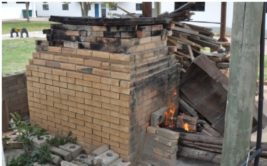
Figura 17 - Durante as 4 horas do esquento, a lenha é empurrada pouco a pouco para dentro do forno, até que alcance toda a sua extensão. Esse processo é feito para as peças irem perdendo água e para que não haja risco delas estourarem.
