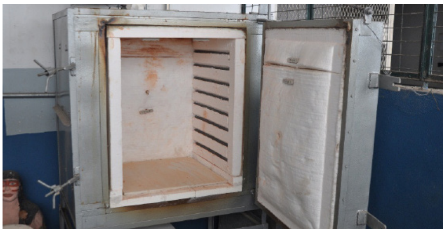
Figura 22 - O forno elétrico, como o nome já sugere, é alimentado pela energia elétrica. Ele é programado para que a queima dure cerca de 8 (oito) horas a uma temperatura de em média 800°C. As peças são arrumadas dentro do forno e então ele é ligado. Ao chegar ao fim do tempo que foi programado, o forno desliga automaticamente.
