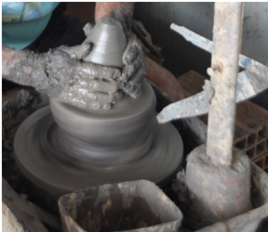
Figura 75 - Ao lado do torno, ficam duas espécies de régua, pois quando são feitas muitas peças sob encomenda e todas devem ser iguais, é preciso usar uma medida.
