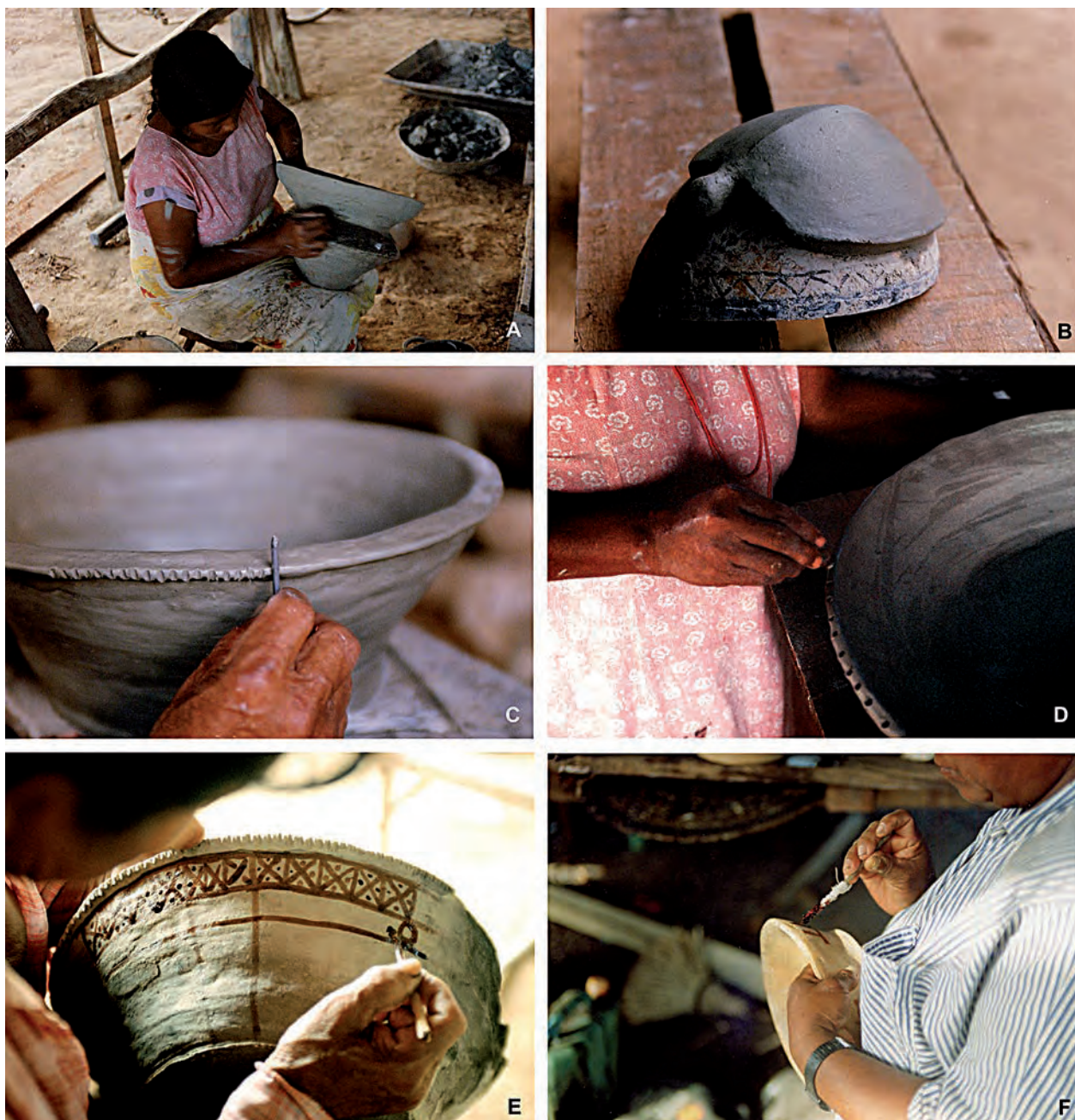
Figura 5. Terminados y decoración. A: Pulimiento de la paredes del recipiente con una fruta de palma maripa. B: Moldeado de una figurina de tortuga sobre una calabaza. C: Incisión del labio del recipiente con un clavo. D: Impresión del labio del recipiente con un palito de madera. E y F: Pintura.
