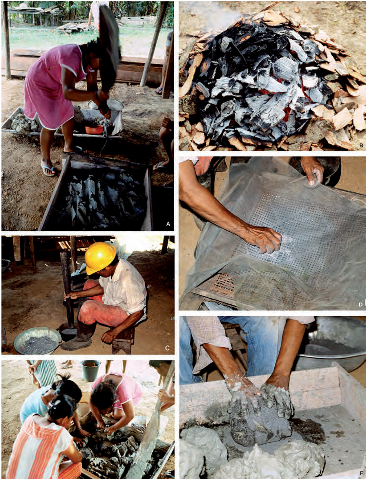
Figura 3. Preparación de la pasta. A: Golpeo de la arcilla para hacerla más homogénea y plástica. B: Quemada de la corteza de kwep . C: Molienda de las cenizas de kwep . D: Tamizado del polvo de kwep . E & F: Mezcla de la arcilla con el desgrasante kwep .
