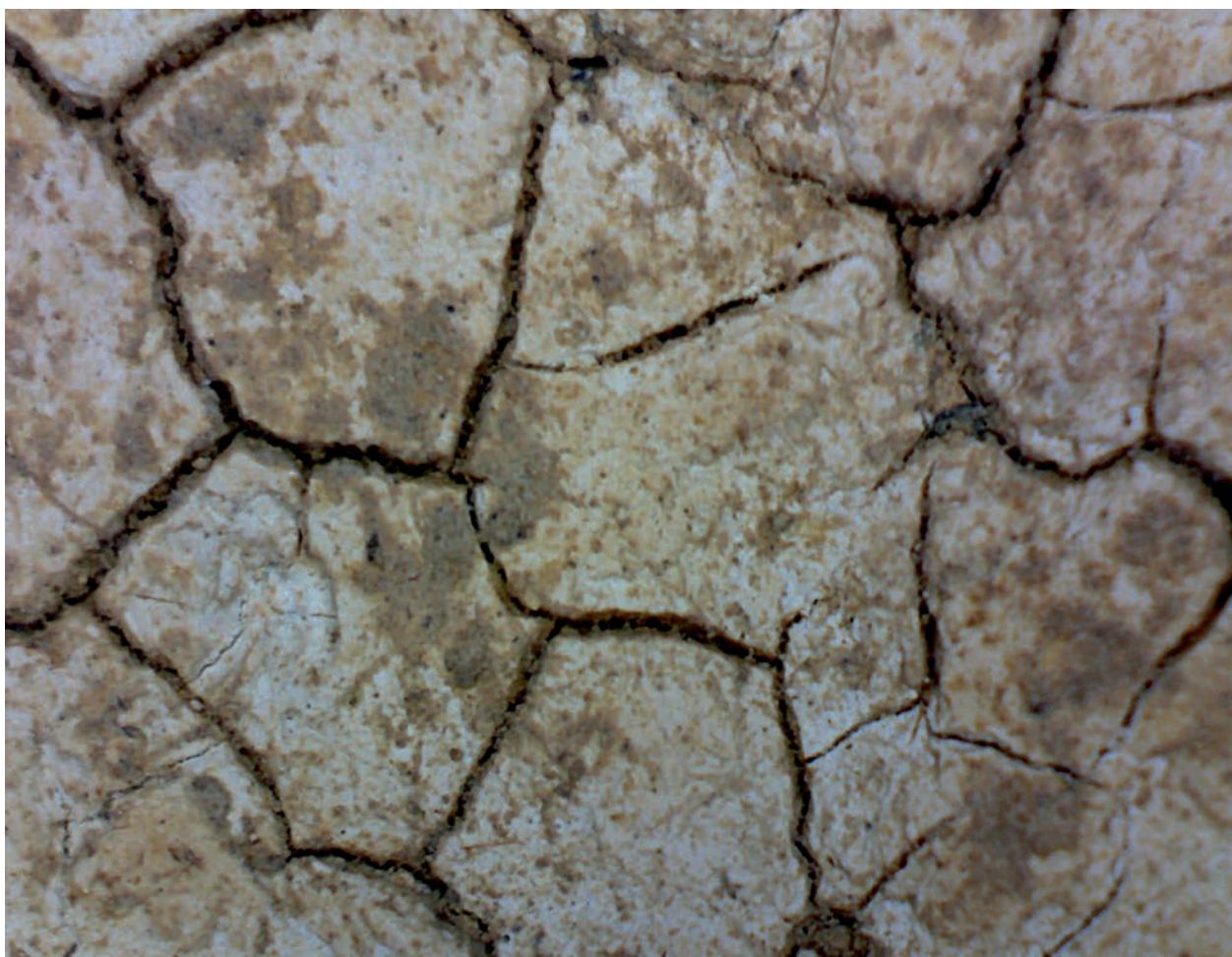
Figura 2. Engobo lavado com craquelamento. Detalhe do craquelamento do engobo na área lavada. Foto: Sílvia Cunha Lima. Acervo: IDS.M.
