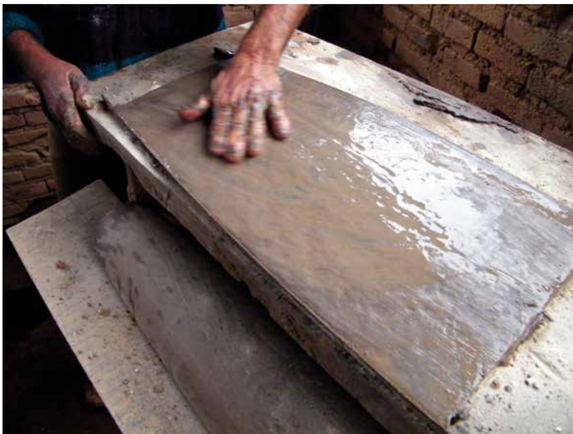
Mestre José Gonçalves alisando a argila enformada na grade
