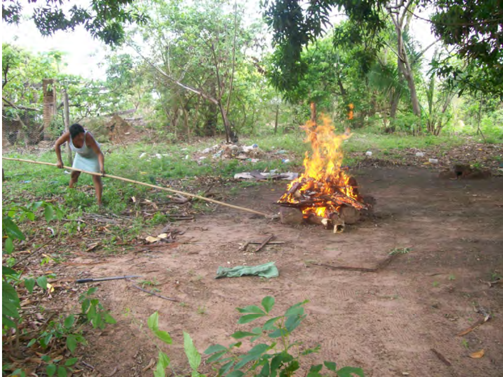
Myixa usa uma vara de bambu com gancho de ferro na ponta para revolver o fogo e as peças na queima da cerâmica. Santa Isabel do Morro, Ilha do Bananal, TO Foto: Rosani Moreira Leitão / outubro de 2009
