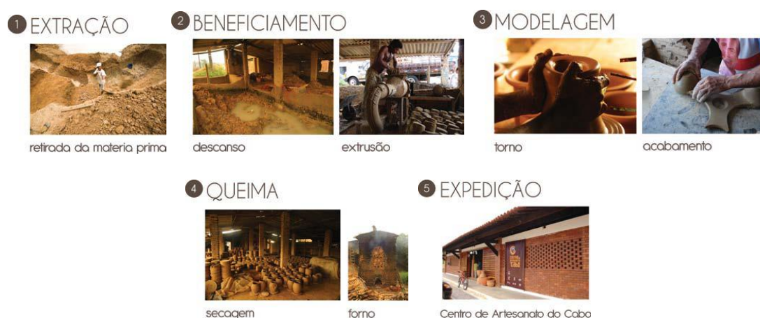
Figura 2. Fluxograma do processo de produção cerâmica
