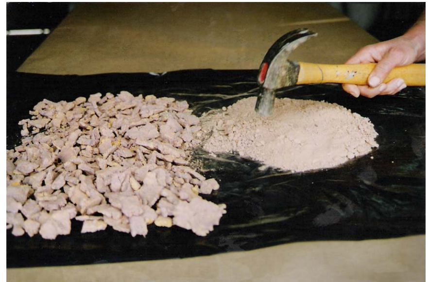
Após sua retirada do rio, o barro vira uma pedra, então deve-se quebrá-lo até virar pó
