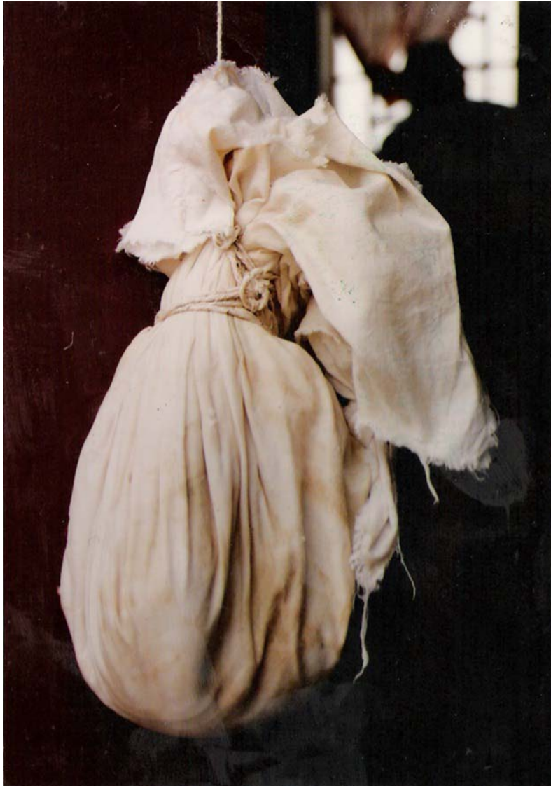
Coloca-se o barro em um pano, embrulha-o e deixe escorrer a água
